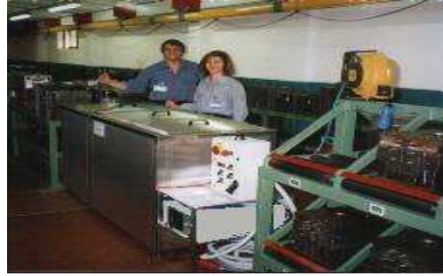
Lavaggio stampi pressofusione e materie plastiche
