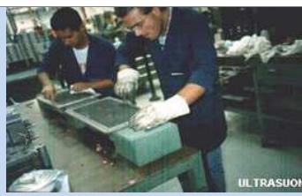
Preparazione flange trasduttori ultrasuoni
