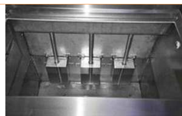
Lavaggio stampi per materie plastiche di precisione per industria, modellismo e giardinaggio. Nella foto i nostri potenti trasduttori IMMERSIBILI in acciaio inox 316 L, serie ULTRAPEZZO HIGH-POWER
