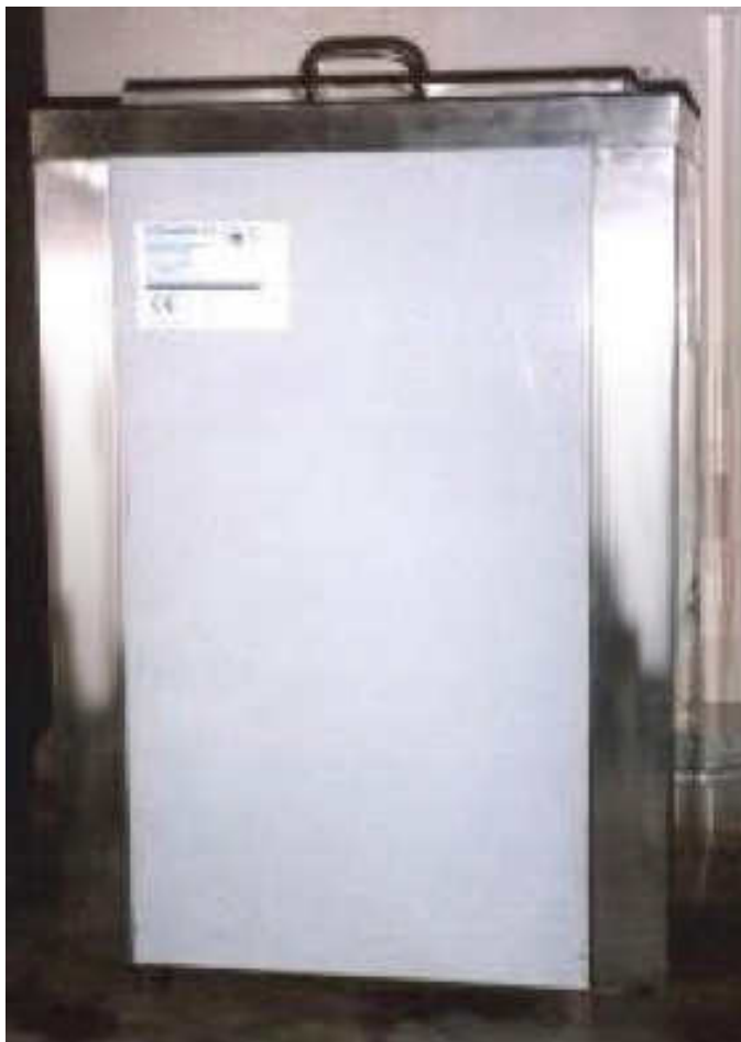
Macchina polifunzionale a detergente acquoso e ecosolvente, risciacquo e soffiatura asciugante ad aria, modello AC 250.
